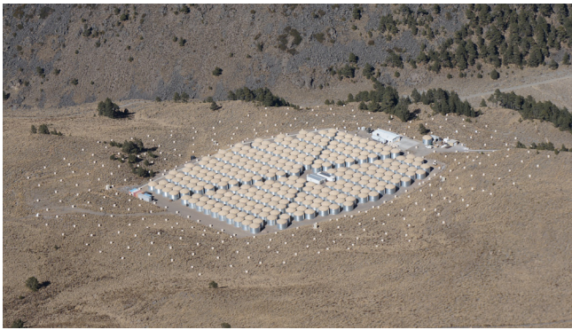
Das Luftbild von HAWC zeigt das Hauptdetektor-Array umgeben von der „Outrigger“ Hochenergie-Erweiterung.
